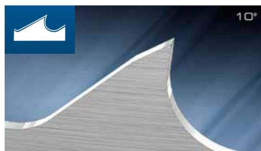
O dente hook (dente em forma de gancho) tem um ângulo de corte positivo de 10°. Este dente é particularmente apropriado para cortar maciços, tubos de parede grossa e materiais de ligas elevadas.
