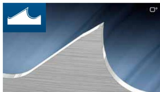
O dente normal tem um ângulo de corte de 0°. É apropriado para corte de metais com alta quantidade de carbono (como ferro fundido), para materiais com pequenas seções de corte transversais e para perfis e tubos de parede fina.
