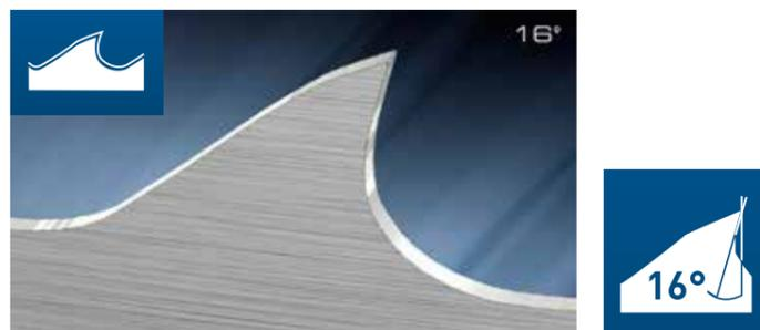
O dente RP tem um ângulo de corte positivo de 16°. Devido às suas características de corte agressivo, é mais adequado para cortar materiais de alta qualidade, ligas exóticas e materiais não ferrosos.
