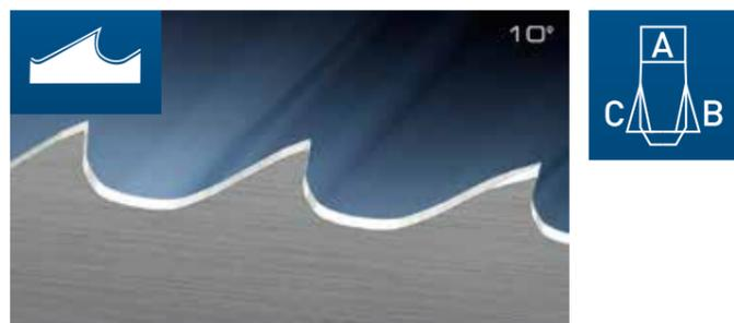
Este desenvolvimento especial consiste em dentes retificados: dente chanfrado pré corte e dentes menores finalizadores. O dente Master é particularmente adequado para cortar ligas exóticas.
