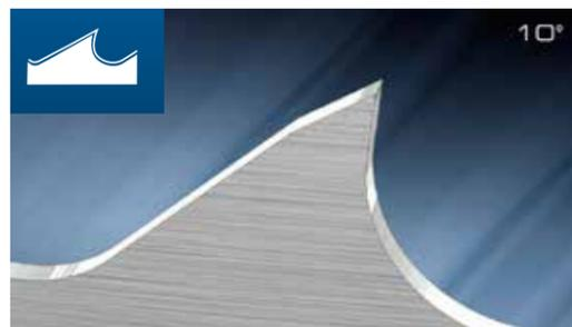
O dente hook (dente em forma de gancho) tem um ângulo de corte positivo de 10°. Este dente é particularmente apropriado para cortar maciços, tubos de parede grossa e materiais não ferrosos.
