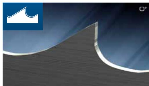
O dente normal tem um ângulo de corte 0°. É apropriado para corte de metais com alta quantidade de carbono (como o ferro fundido), para materiais com pequenas seções de corte transversais e para perfis e tubos de parede fina.
