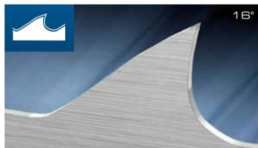
O dente RP tem um ângulo de corte positivo de 16°. Devido às suas características de corte agressivo, é mais adequado para cortar materiais de alta qualidade, ligas exóticas e materiais não ferrosos.
